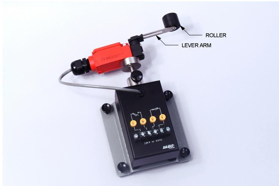
Figure 30. Limit Switch module.
